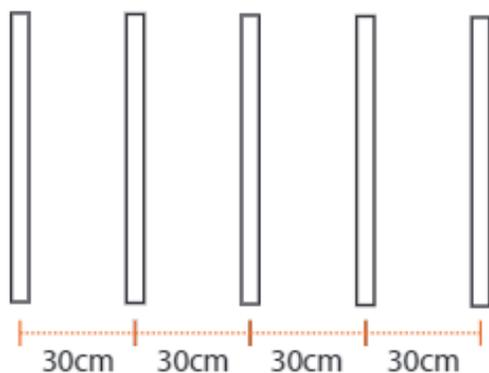
Los listones de madera o metal deben ir a las medidas indicadas. Los Wall Panel deben ir apoyados de tres listones y deben ser fijados sobre los mismos.
