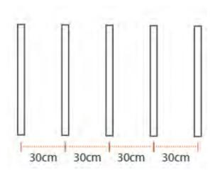
Los listones de madera o metal deben ir a las medidas indicadas. Los Wall Panel deben ir apoyados de tres listones y deben ser fijados sobre los mismos.
